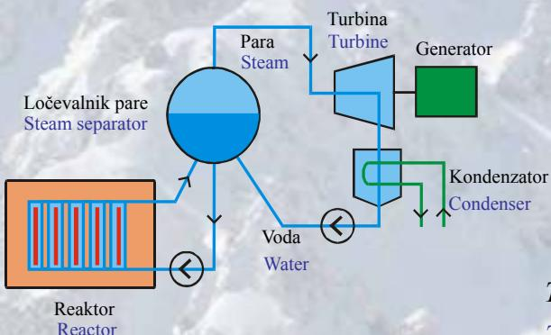
Moderirana je z **grafitom** in hlajena z **navadno vodo**. Voda vre v reaktorju, para se loči od kapljivine v ločevalniku pare.
