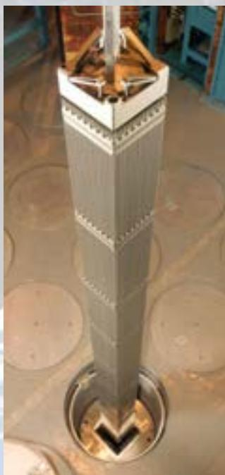
**Gorivni element** je snop gorivnih palic. Reaktor jedrske elektrarne Krško vsebuje 121 gorivnih elementov, vsak izmed njih vsebuje 235 gorivnih palic.
