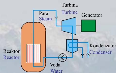
*Vrelna elektrarna je podobna termoelektrarni, le da ima namesto kotla reaktor.
